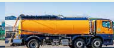
タンクローリー(アスファルト)
